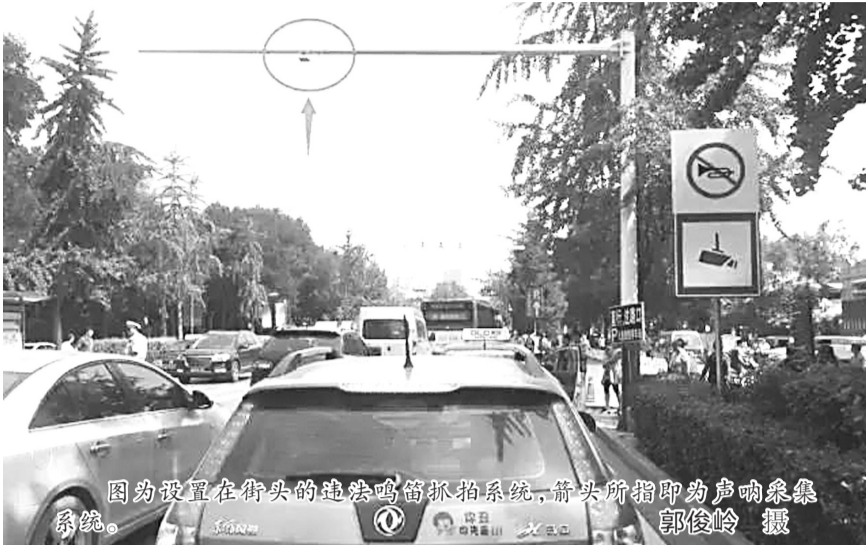
图为设置在街头的违法鸣笛抓拍系统,箭头所指即为声呐采集系统。
